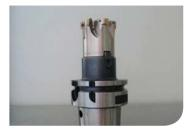
Conventionnal milling (SECO tools) cutter : R220.29-0040-06.4A insert : RPHT 1204MOT-M15
